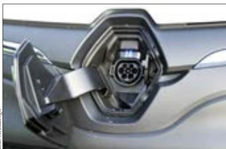
Gut verdeckt: Der gewohnte „Tankstutzen“ ist einer Steckdose in der Kühlerfront gewichen.
